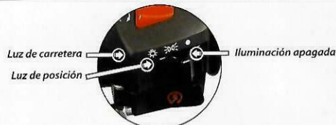
Imagen 2. Interruptor de luz delantera.
