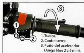
Imagen 18. Ajuste del puño del acelerador.
