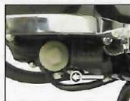
Imagen 15. Ubicación del tornillo de drenado.
