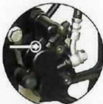
Imagen 21. Indicador de desgaste del freno delantero.
