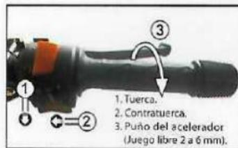
Imagen 18. Ajuste del puño del acelerador.
